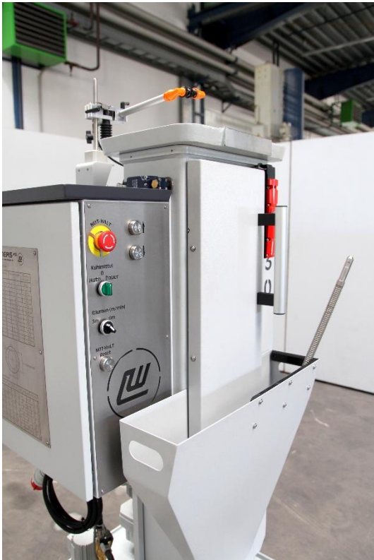
Ansicht Schiebetür mit Späneschütte mit Werkzeugablage (Standard Ausstattung)
