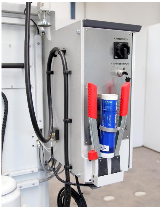
Rückseite Schaltschrank mit Fettpresse, Rückhub- Schlüsselschalter, rückseitigen Schmierpunkten der Spindelmuttern und extra langer Kühlmittelzufuhr- Leitung (Standard Ausstattung)
