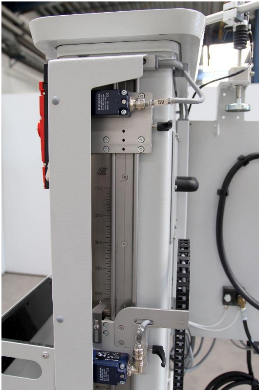
seitliche Maschineansicht mit leichtgängiger Hubverstellung und Schutzverkleidung (Standard Ausstattung)
