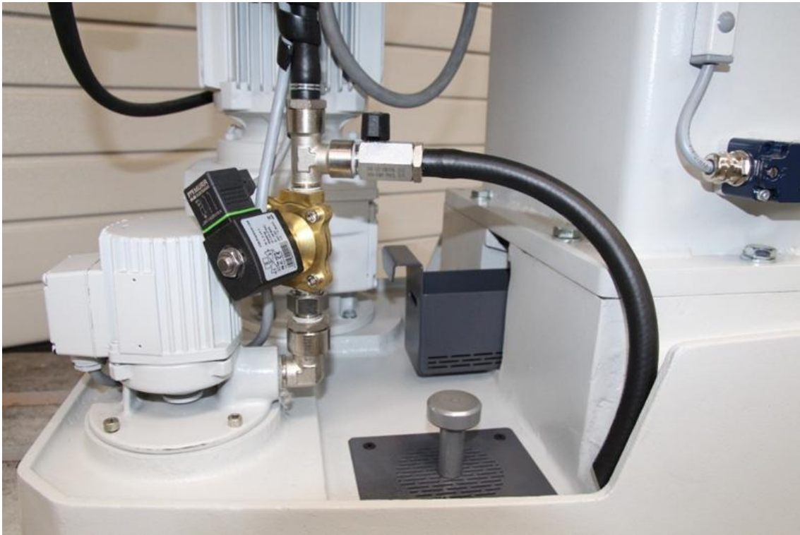
Kühlmittelpumpe mit über dem Kühlmittelschwenksystem geschaltetem Magnetventil, Spänesieb mit Permanentmagneten und extra stabilem Spänekorb aus 2mm Stahlblech ( Standard Ausstattung )
