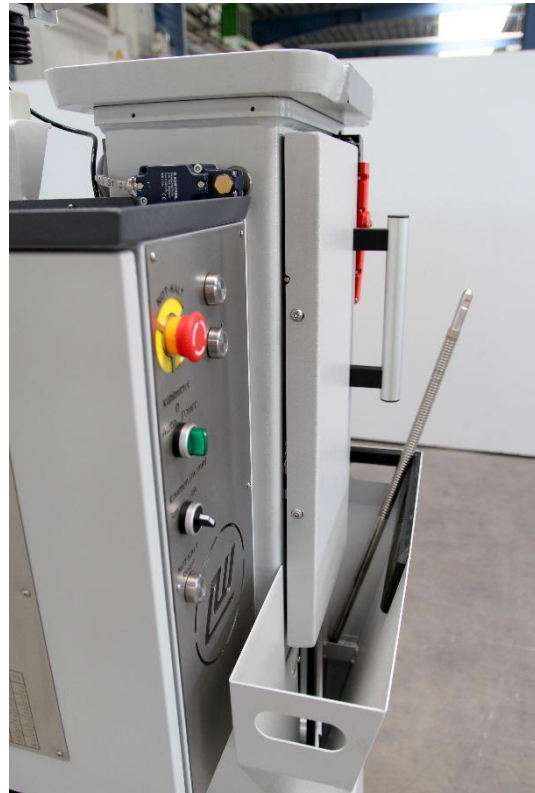
Detailbild Späneschütte mit Werkzeugablage und Werkzeugschneiden- Schutzbeplankung (Standard Ausstattung)
