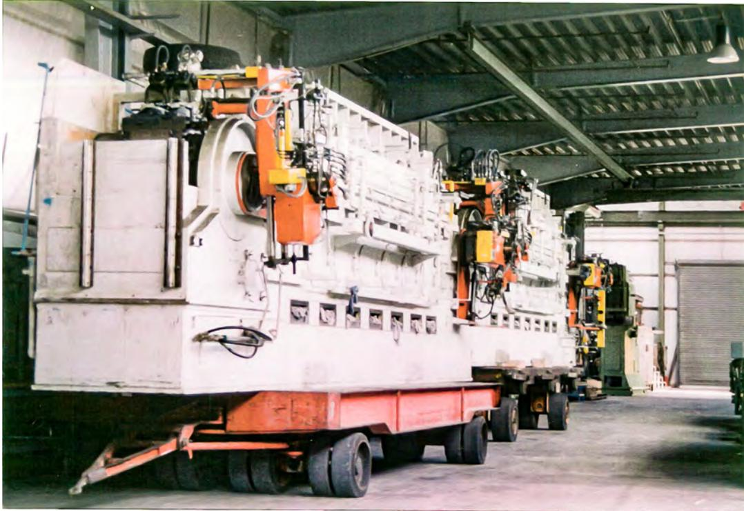
Maschine demontiert auf Schwerlastanhängern
