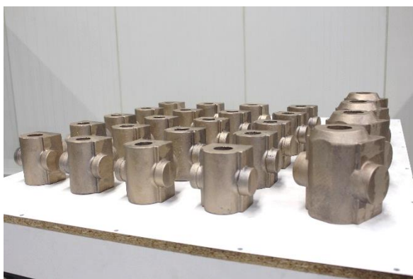
Bild mit diversen gegossenen Spindelmutter für die Maschinen der Baureihe RS 3 und RS 6
