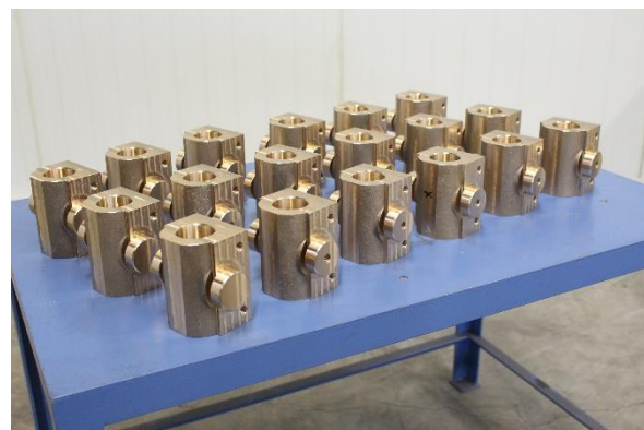
Bild mit fertig bearbeiteter Außenkontur der Spindelmutter für die Baugröße RS 3 ohne das Trapezgewinde (wird auf die Mutter angepasst)
