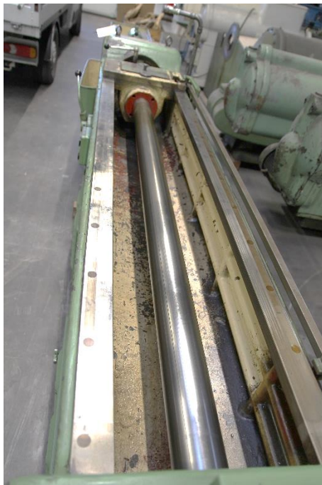
Flachführung der Zugbrücke mit Hydraulikkolbenstange
