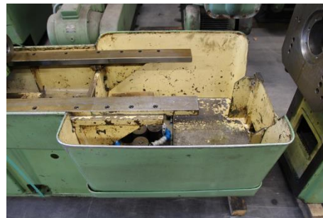
Spänwanne des Werkzeug – Zubringers (max. Werkstück Ø ca. 800mm)
