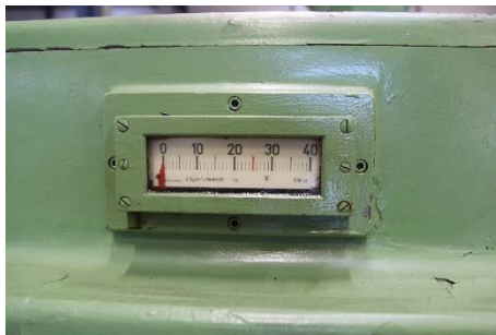
Zugkraftanzeige der Maschine bis 25.000kg
