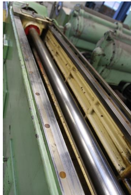
Flachführung der Zugbrücke mit Hydraulikkolbenstange
