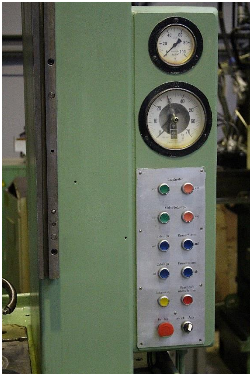
Bedientafel mit Zugkraftanzeige & Begrenzung
