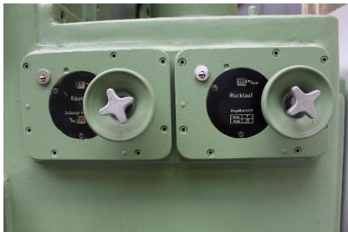
Verstellung Räum & Rücklaufgeschwindigkeit
