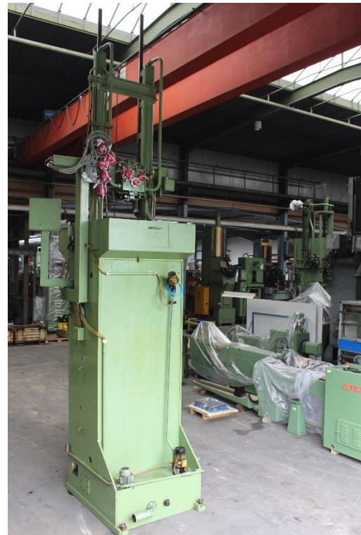
Maschinen-Rückseite mit zusätzlichen Kühlmittelpumpen
