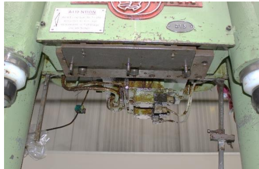
Unterseite hydr. Verriegelungssystem für den Nadelaushebekopf des Werkzeugzubringers
