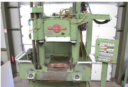
Arbeitsfeld mit Zweihandauslösung und Bedienpanel
