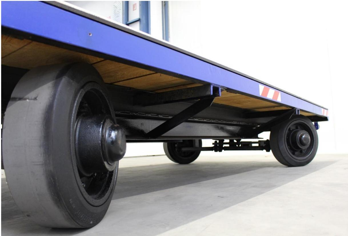
neuer Unterboden aus massiven Holzbohlen / Rahmenverstärkung durch Zusatzstahlprofil
