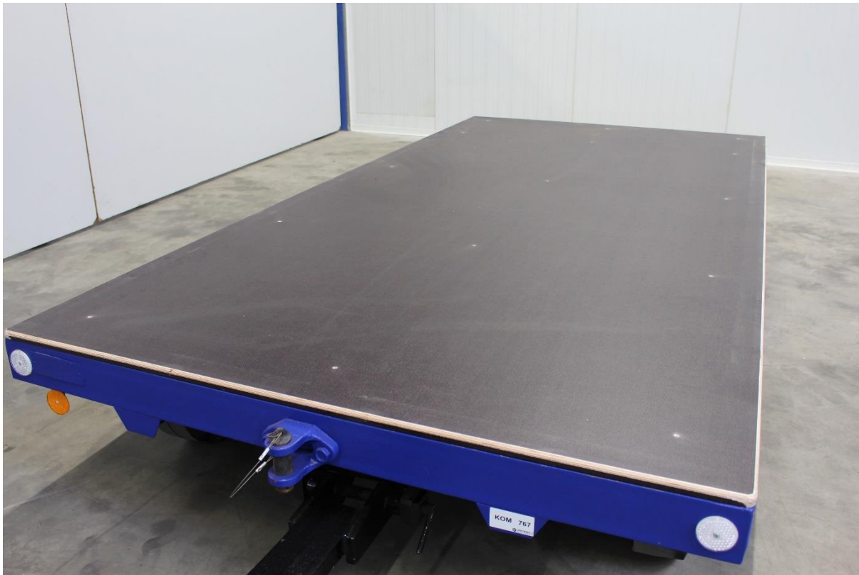
neuer Ladeflächenbelag aus 18mm Fahrzeugbauplatte
