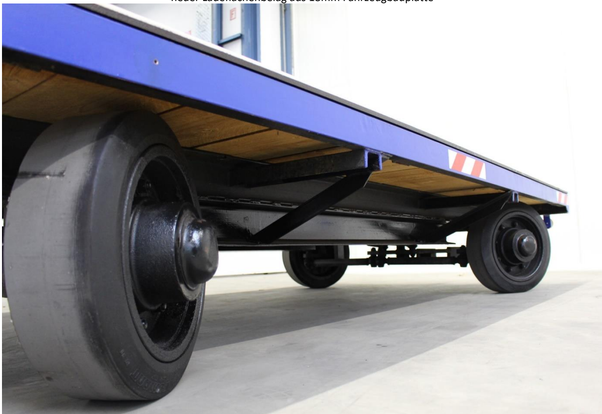
neuer Unterboden aus massiven Holzbohlen / Rahmenverstärkung durch Zusatzstahlprofil
