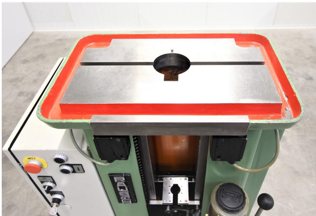
Maschinentisch mit Zugbrücke in der Draufsicht
