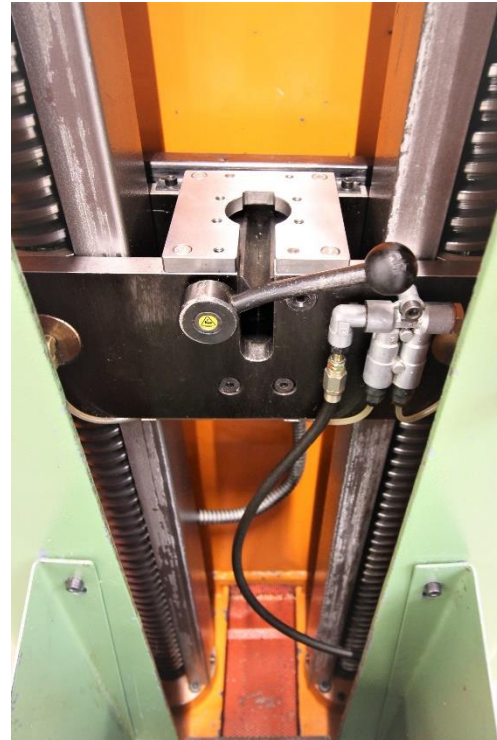
Maschinen- Innenansicht mit universal Spannbacken- Ziehkopf für Flachsäfte
