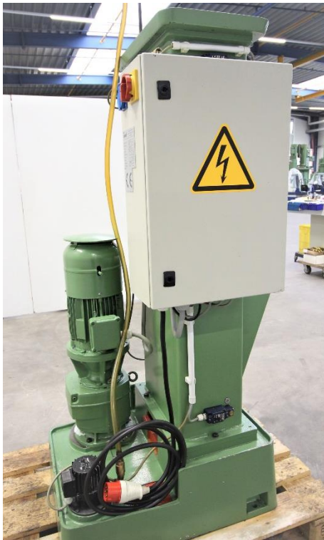
Ansicht Maschinenseite links mit Schaltschrank &amp; integrierter Kühlmitteleinrichtung
