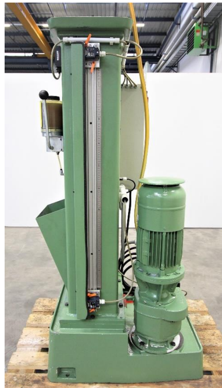
Ansicht Maschinenseite rechts mit mechanischem Hauptantrieb
