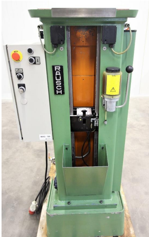
Maschinen- Vorderansicht mit Zugbrücke und Bedienpanel mit Zugkraftanzeige
