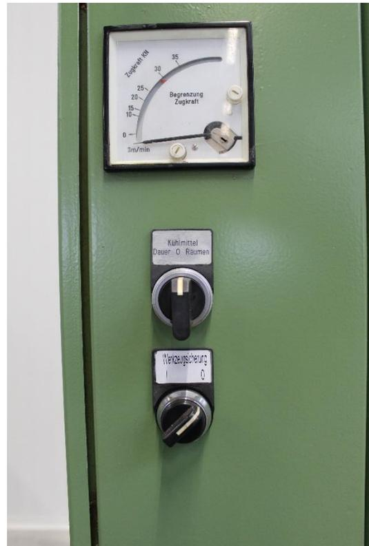
Einstellung der Zugkraft & Zugkraftanzeige
