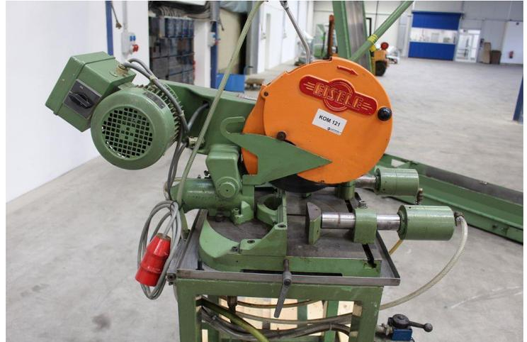
Achtung, die Maschine ist ein Schnellläufer mit Umdrehungen von 1000 und 2000 1/min vermutlich nur für Aluminium Holz & Kunststoffe) zu verwenden.
