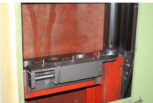
Ziehkopfbrücke mit hydraulischer Verriegelung
