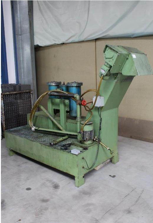
Kühlmittelanlage mit Späneförderer &amp; Feinfilter
