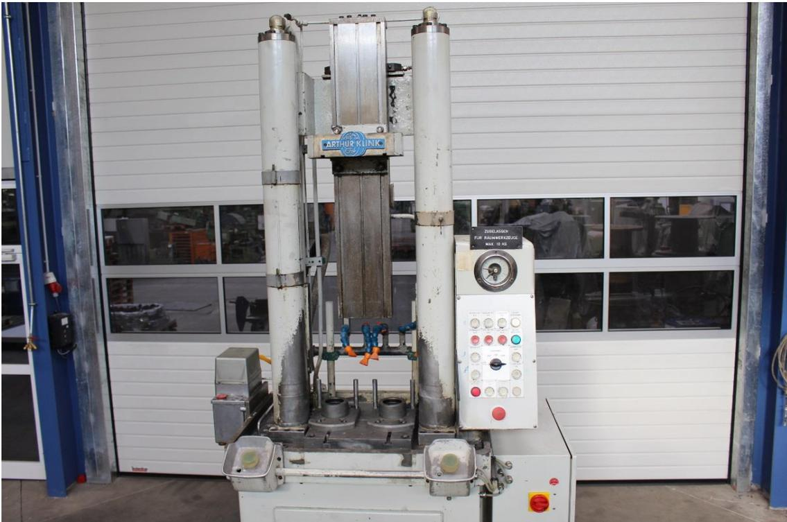
Maschinenoberteil mit Bedienerumfeld und 2 Hand - Auslösung
