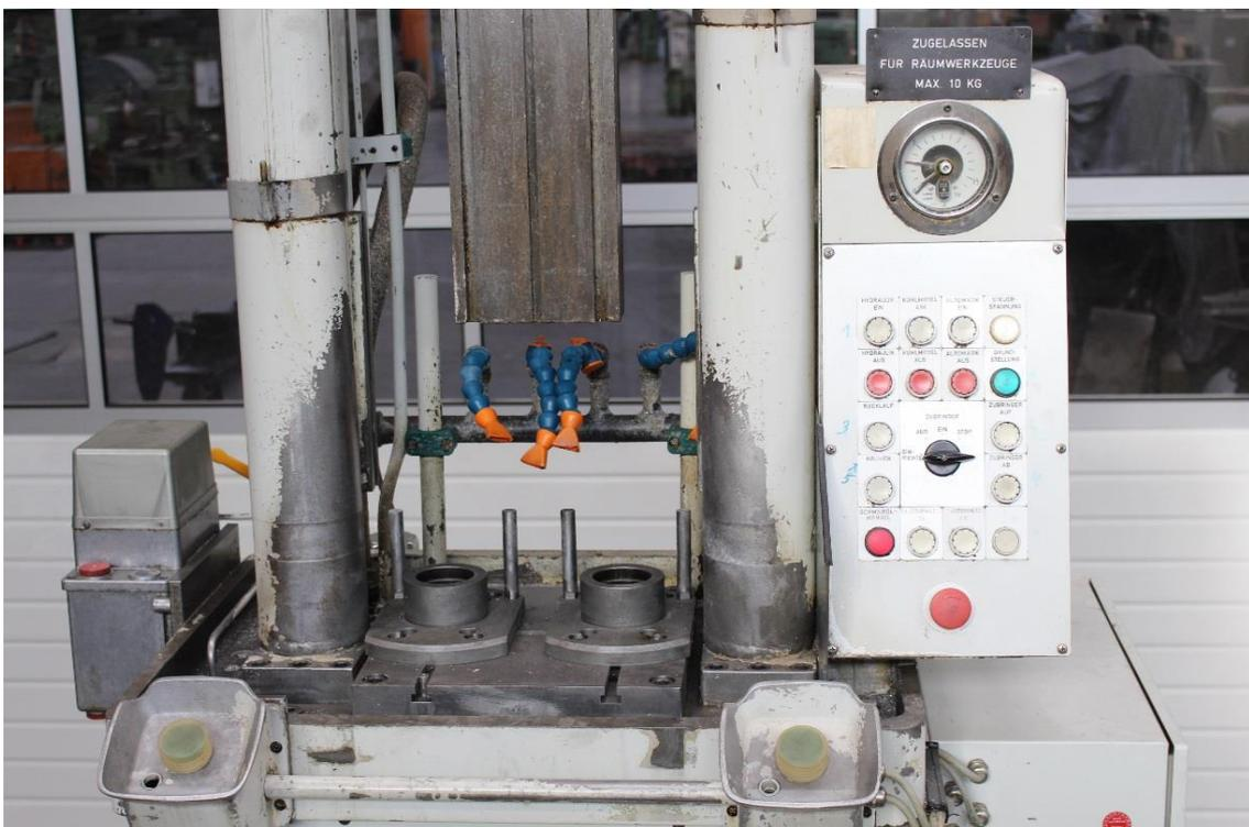
Werkstücktisch mit Bedienpanel, Zugkraftanzeigen und 2Hand -Auslösung
