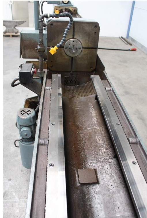
Werkstücktisch mit Kühlmittelanlage &amp; Führung des Werkzeugzubringers
