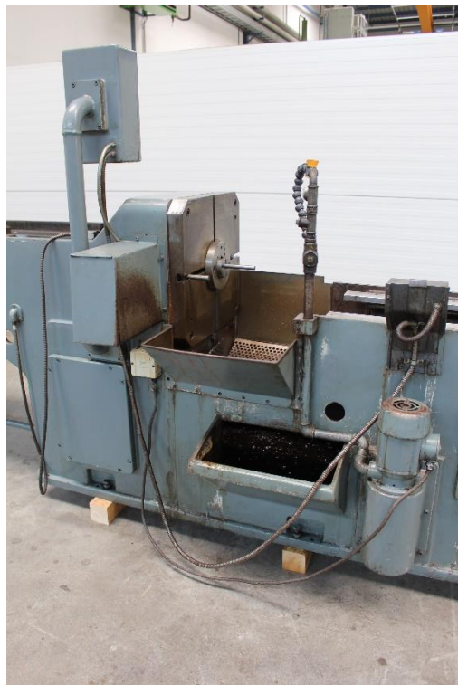
Werkstücktisch mit Spänefang &amp; Kühlmittelanlage
