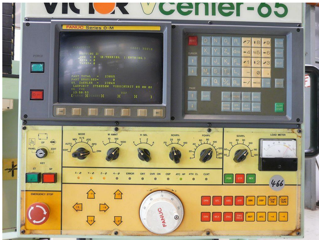
Bedienpanel Fanuc Steuerung
