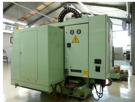
Seitenansicht rechts mit E-Schaltschrank
