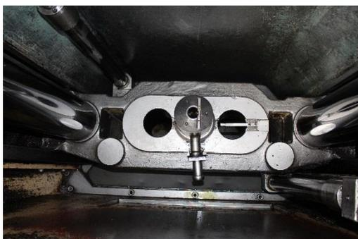
Ziehkopfbrücke mit hydraulischer Verriegelung
