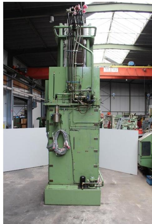
Maschinen-Rückseite mit Kühlmittelpumpen
