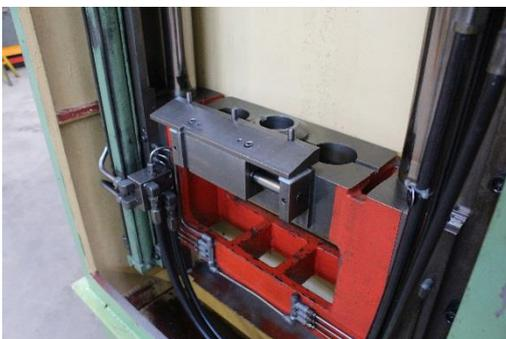
Ziehkopfbrücke mit hydraulischer Verriegelung
