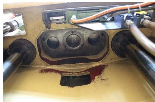
Unterseite Werkstücktisch für 3 Werkstücke
