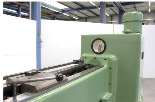
Ziehkopf mi Zugkraftanzeige
