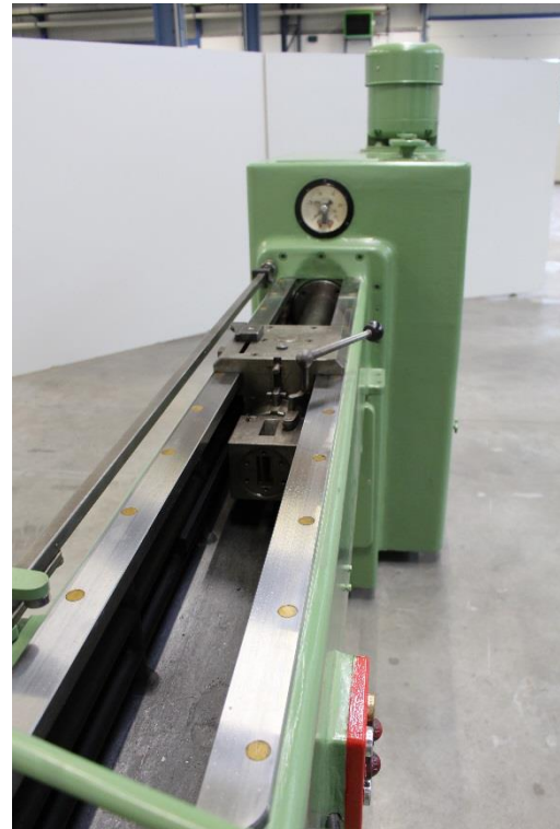
Führung Zugbrücke mit Ziehkopf
