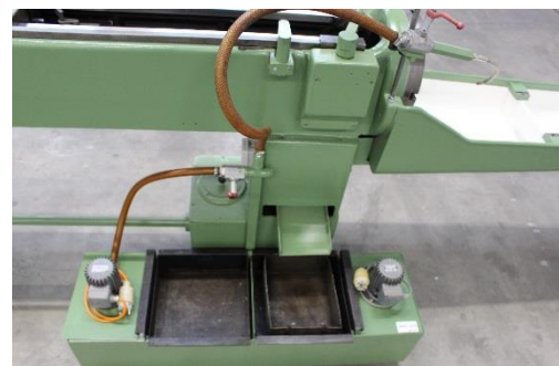
Kühl- Schmiermittelanlage mit Spänefang verschiebbar für 2 verschiedene Medien
