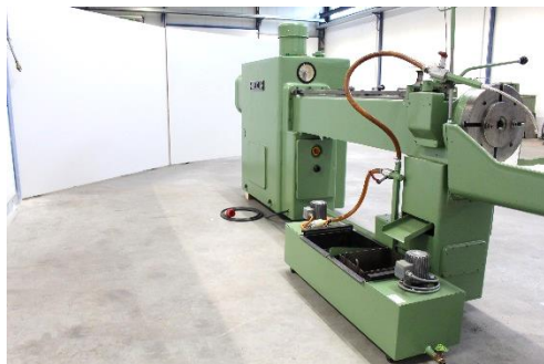
Rückseitenansicht mit Kühlmittelanlage
