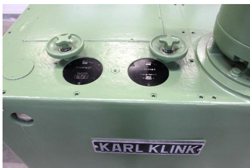
Verstellung der Räum- & Rücklaufgeschwindigkeit
