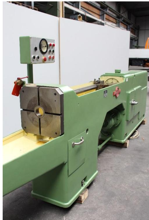
Führung mit Zugbrücke mit Ziehkopf
