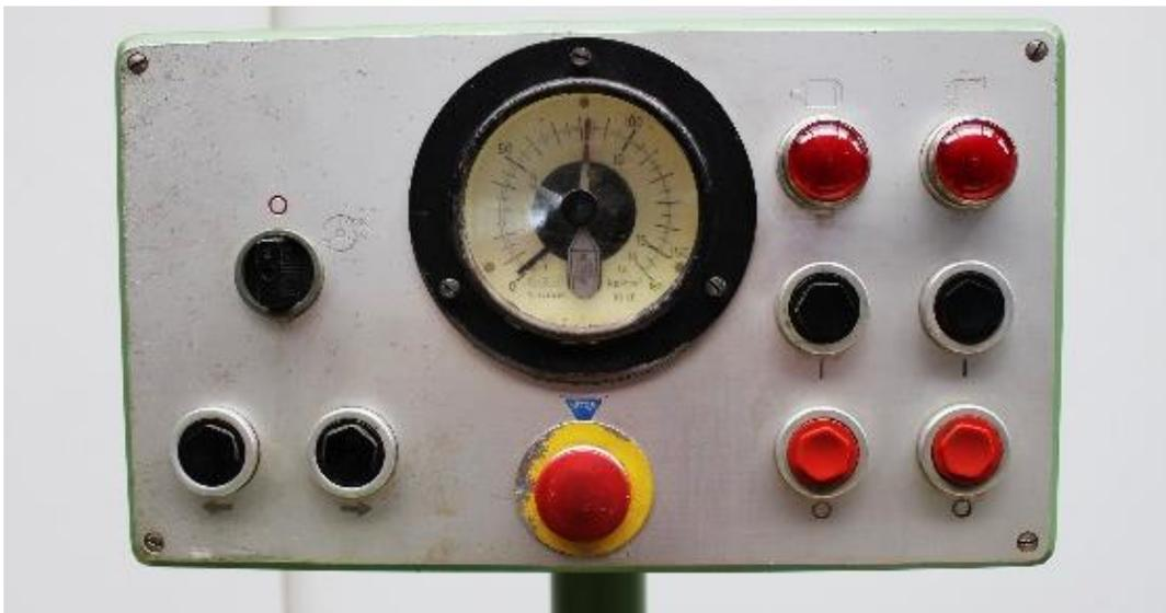
Bedienpanel mit elektrischer Ansteuerung und Zugkraftanzeige
