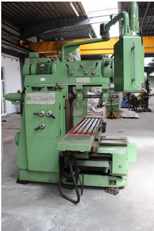
Maschinenaufbau mit einzel Getrieben für vertikal und horizontal Spindel ( Abbildung von baugleicher Maschine ( WKG 374))
