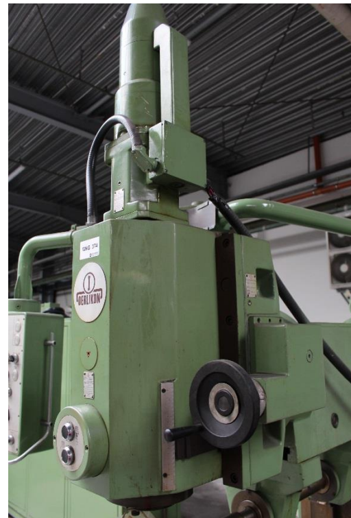
zusätzliche Vertikal-Spindelzustellung über manuelles Handrad ca. 150mm
