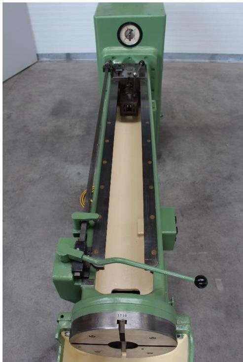
Werkstücktisch und Werkzeugschlittenführung
