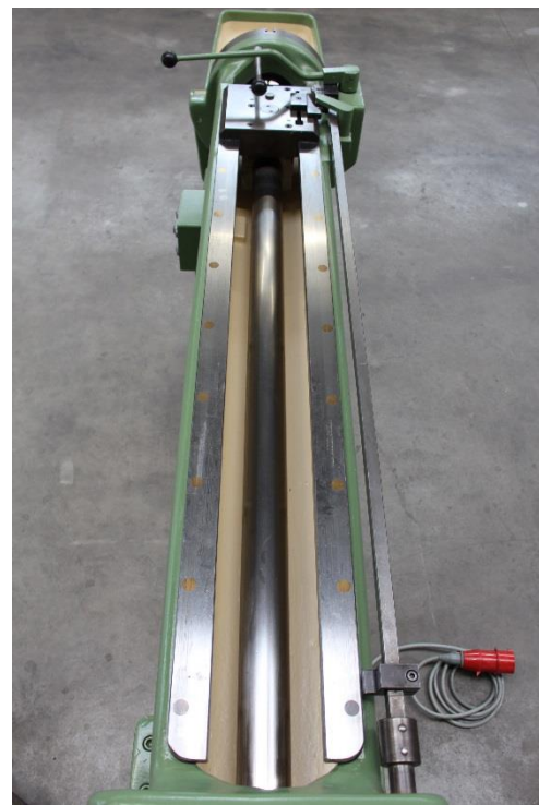
Zugbrücke mit Führung
