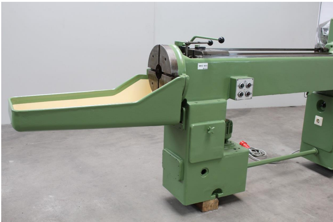
Arbeits- und Bedienfeld zur mechanischen Betätigung des Räumhubes bzw. Rücklaufes
