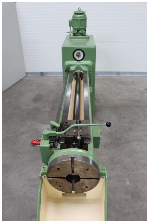
Werkstücktisch und Werkzeugschlittenführung
