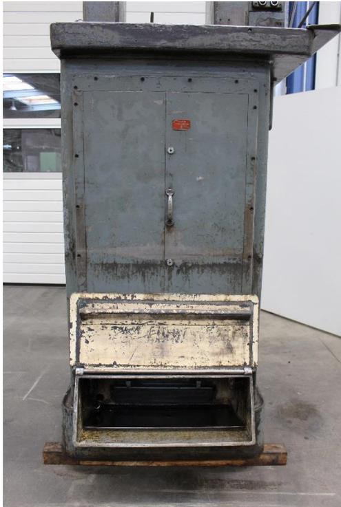
unterer Maschinenaufbau mit Spänewanne
