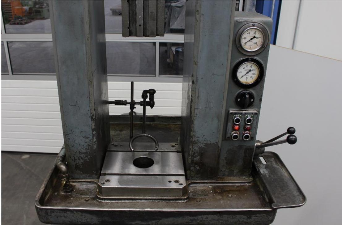
Werkstücktisch mit Bedienpanel, Ziehkraftbegrenzer & Druckanzeige
