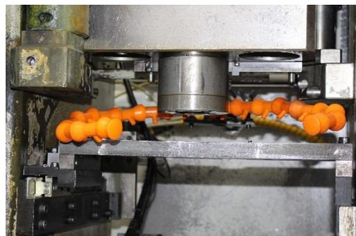
hydraulische Verriegelung für 3 Nadelaushebeköpfe
