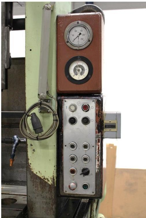
Bedienpanel mit Zugkraftanzeige
