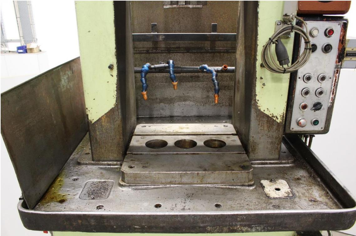
Maschinentisch mit Bedienpanel und Kühlschmiermitteleinrichtung
