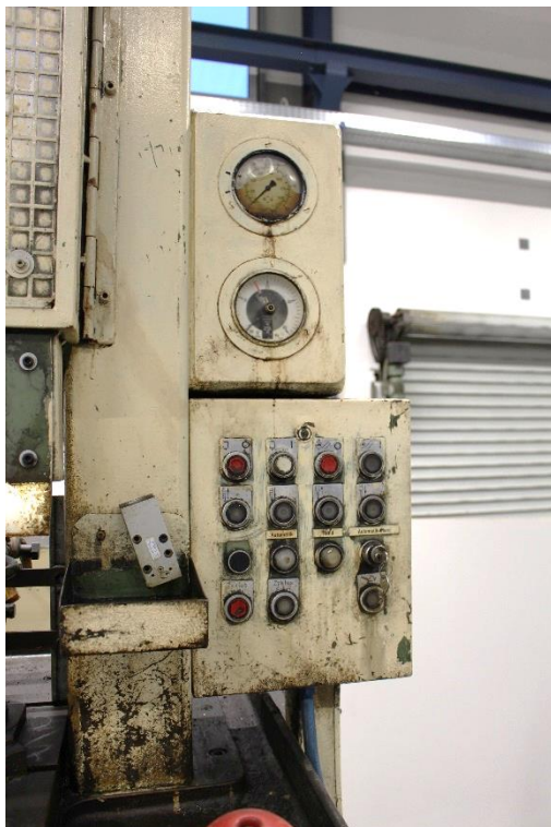
Bedienpanel mit Zugkraftanzeige und Zugkraftbegrenzungsanzeige
