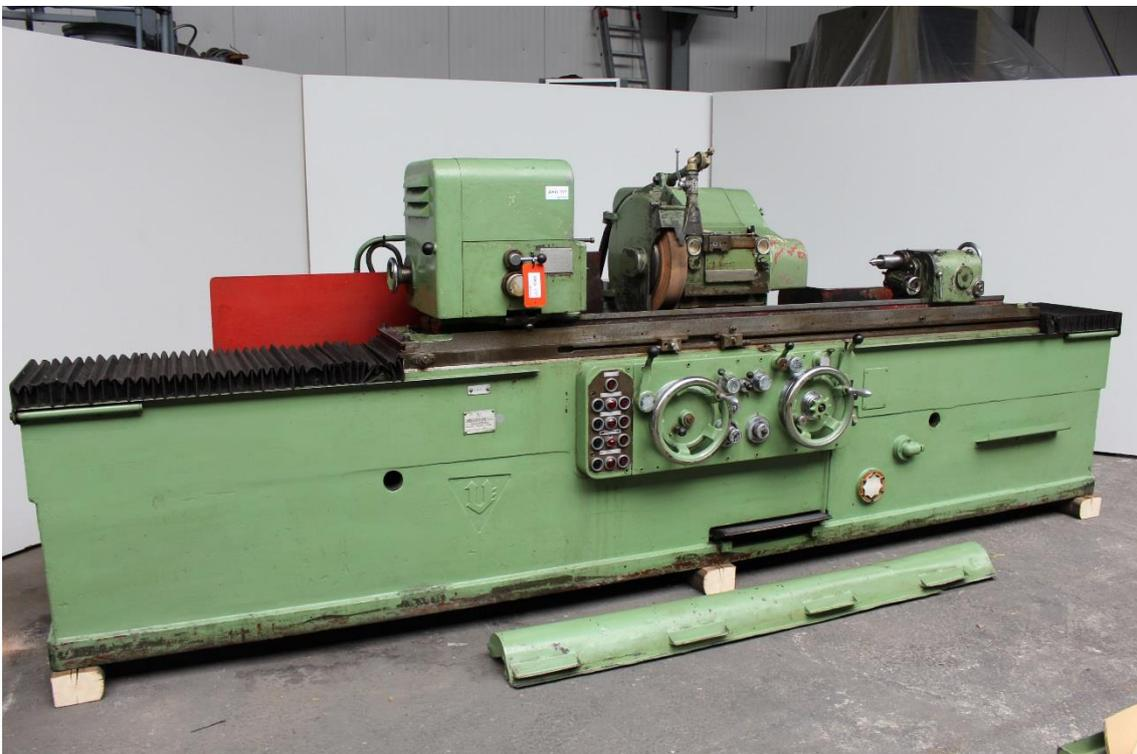
**Außen Rundschleifmaschine Vögele (WKG 777)**
